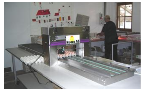
Abbildung 1: Eiersortieranlage: Diese Maschine dient zur Anbringung des Hofkodexes
